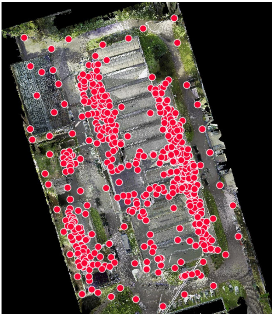
Obrázok 3: Výsledné mračno bodov spolu s postaveniami skenera, ktoré sú reprezentované červenými bodmi.
