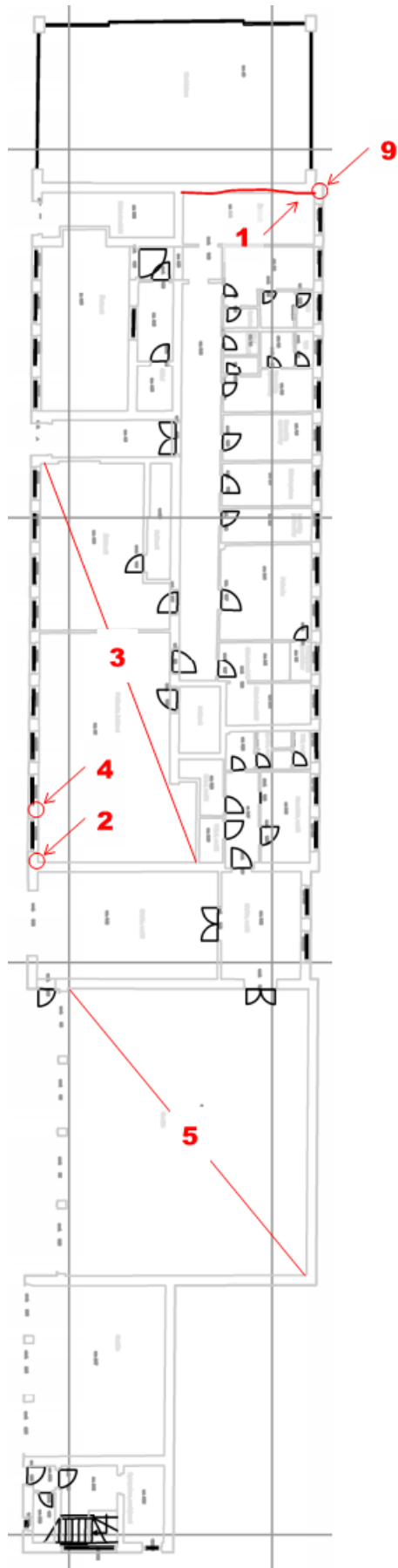
Obrázok 1.5 Pôdorys 1.NP pracovne / sušiarne, garáže a bytu správcu s vyznačením porúch
