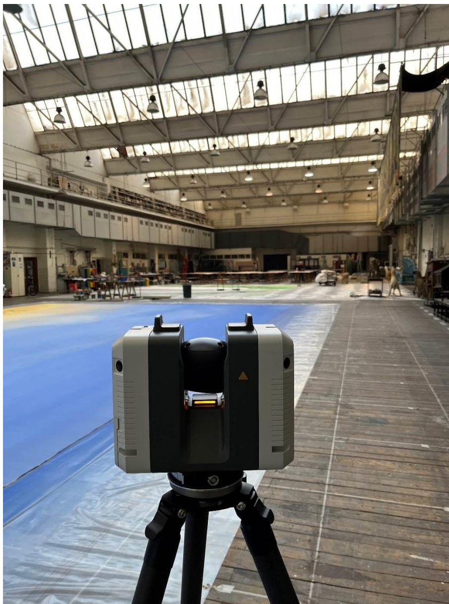
Obrázok 39: Skener Leica RTC360 pri skenovaní maliarskej dielne v priestoroch UDD SND
